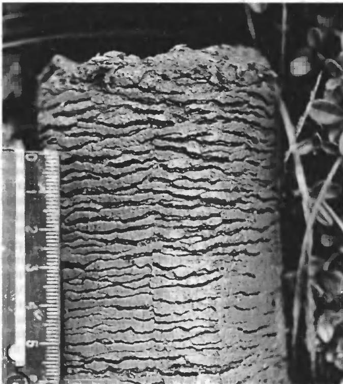
*Мелкие ледяные шлиры в вечномерзлых породах (керна, полученный при бурении скважины) в долине нижнего течения р.Виллюй (Центральная Якутия).*
